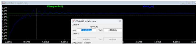
Figure 36. Réponse en échelon  $C_2 = 100$  nF et  $pc1$
