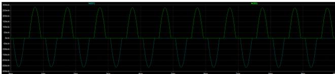
**Figure 4.** Résultats de la simulation: courants de collecteur des deux transistors
